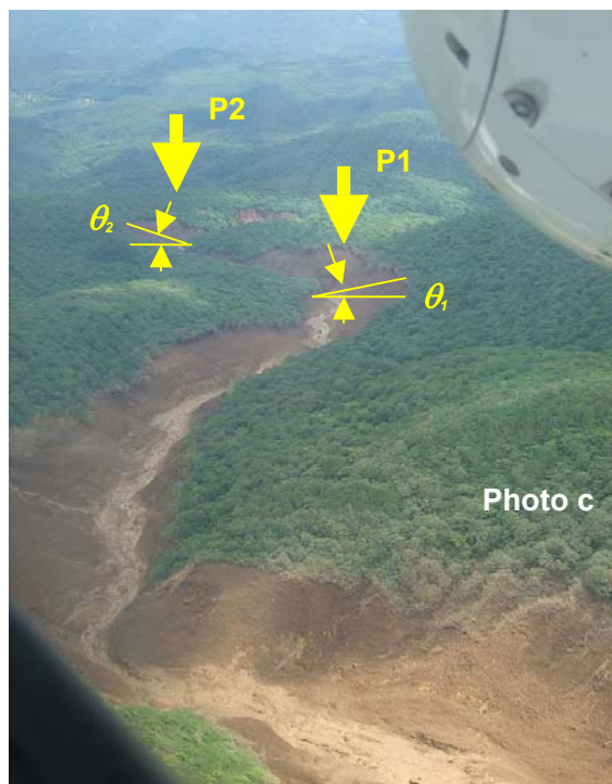
図5 土石流速度 v の大まかな推定：マニングの式から推定する方法、ダイラタント流体を仮定する方法（高橋, 1977）などがあるが、土石流が蛇行水路を通過する時、遠心力がかかって水面が傾く（傾斜 \theta ）状況から推測する。
