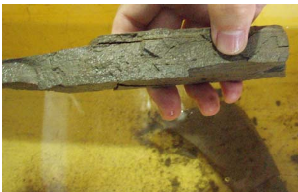
(2) 水浸後堆積層面で分離したサンプル
