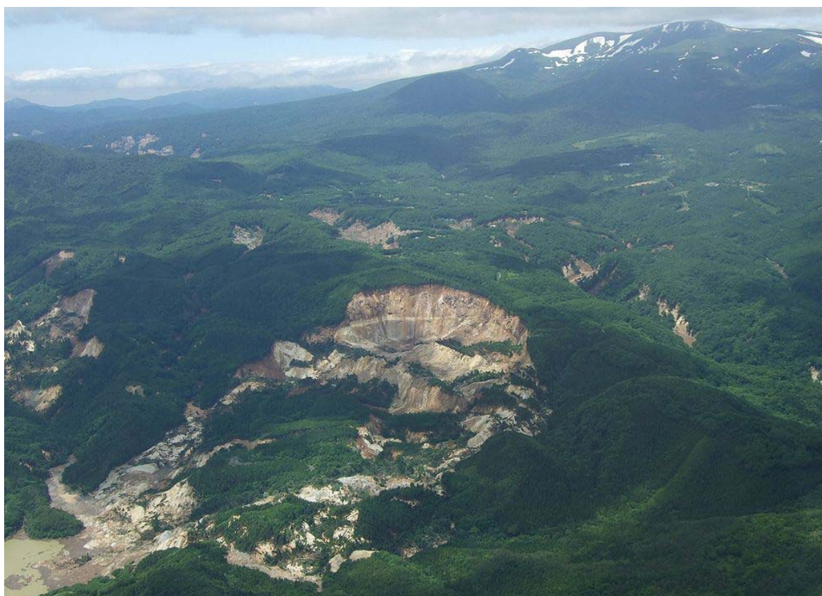
図 1. 荒砥沢ダム湖北部の斜面崩壊全景: 背後に栗駒火山。地形図、次頁図 2 の崩壊し残った部分にも昔の地すべり地形の痕跡? 露出した滑落崖のおよそ中段以下はほぼ水平に堆積した火山砂、火山灰の様子。下端部圧縮リッジの前面には湿潤な泥の流れた跡。尖端部採取した岩片 (図 3) の乾燥後の見かけ比重は 1.16-1.18 程度で極めて軽い。(写真撮影 小長井一男, 2008.06.15)
