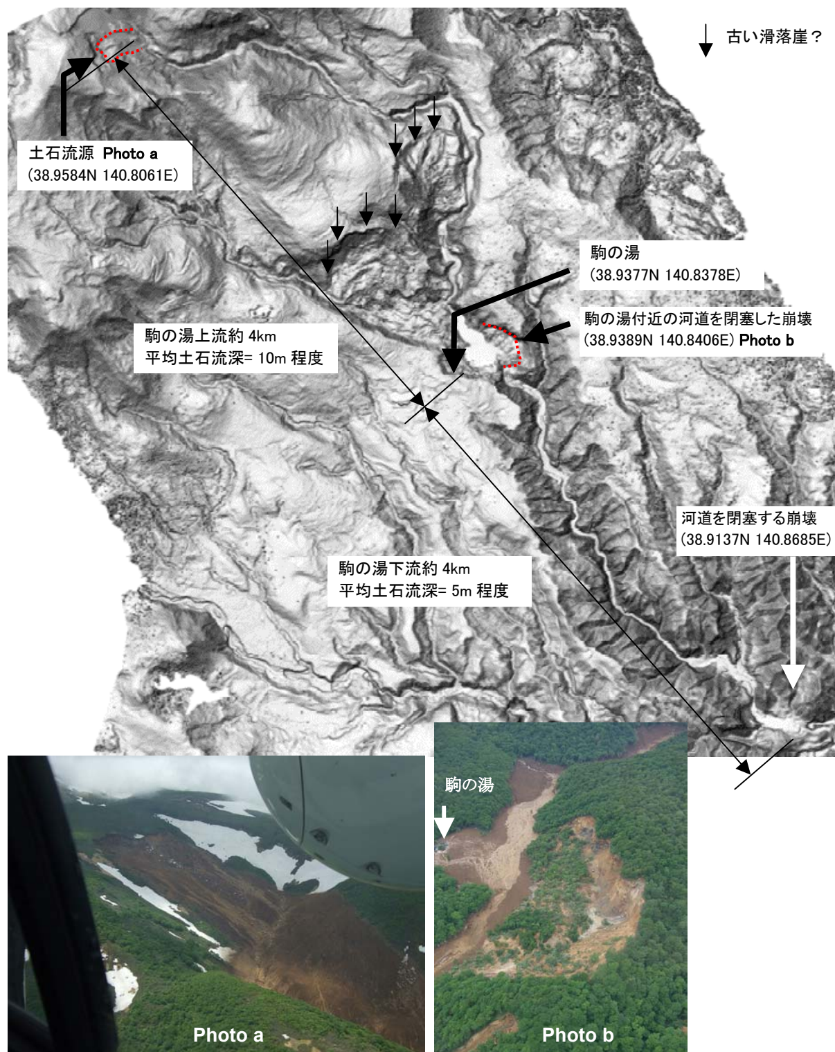
図 4. 駒の湯を襲った土石流：東栗駒山の雪形直下あたり（38.9584N 140.8061E）で発生した崩落は土石流となって 4km 下流にある駒の湯（38.9377N 140.8378E）を襲った。この土石流が駒の湯に到達する以前にやや下流部（38.9389N 140.8406E）で斜面崩壊があり河筋を閉塞したことで行き場を失った土砂が駒の湯を押し流したと推測される。ヘリコプターからの視認であるが、駒の湯上流部 4km と下流部 4km で平均土石流深がそれぞれ 10m、5m 程度と異なる。下流部の土石流は駒の湯よりおよそ 4km 下流部、行者滝のあたりで発生した斜面崩壊（38.9137N 140.8685E）で堰き止められている。（DEM 提供：朝日航洋（株））
